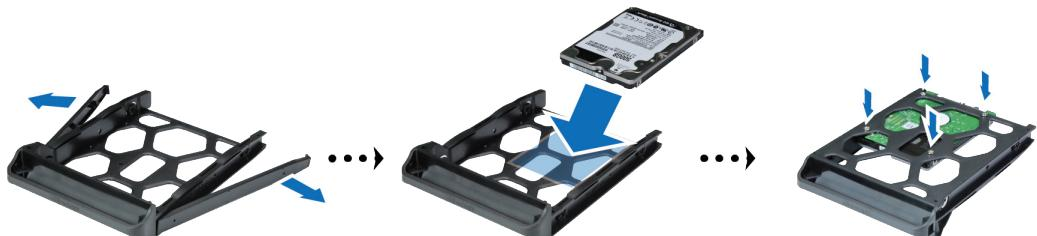
**4** Поверните диск стороной с отметкой "UP" вверху и вставьте его в отсек для дисков. Если лоток вставлен правильно, раздастся щелчок.
