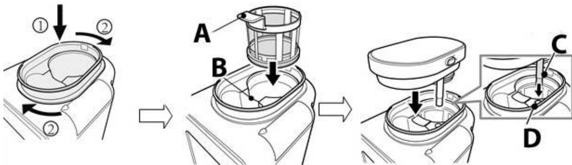
Mahl-und-Brüh-Behälter einsetzen, ein Klickgeräusch ist zu hören (1), im Uhrzeigersinn drehen, bis der Behälter einrastet.
