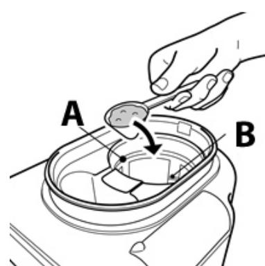
Öffnen Sie den Deckel des Mahl-und-Brüh-Behälters. Füllen Sie in den Filter (A) die gewünschte Menge Kaffeepulver oder Kaffeebohnen ein, siehe Mengen-Markierung (B).
