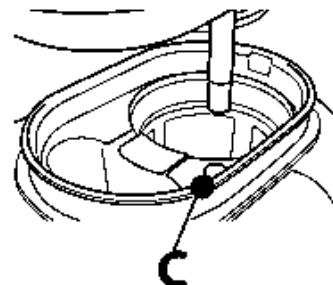
Coloque la jarra sobre la placa de mantenimiento del calor inclinándola ligeramente al introducirla.
