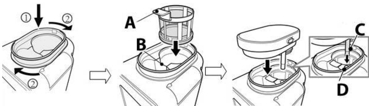
Maal-en-zet-houder plaatsen, er is een klik te horen (1), met de wijzers van de klok mee draaien, tot de houder op zijn plaats zit. Filter aan handgreep (A) vastpakken en in de maal-en-zet-houder op positie A zetten. Deksel op de maal-en-zet-houder plaatsen, en erop letten dat de waterslang C in de waterinlaat D moet worden gestoken, en vervolgens het deksel naar beneden drukken tot deze vastzit.
