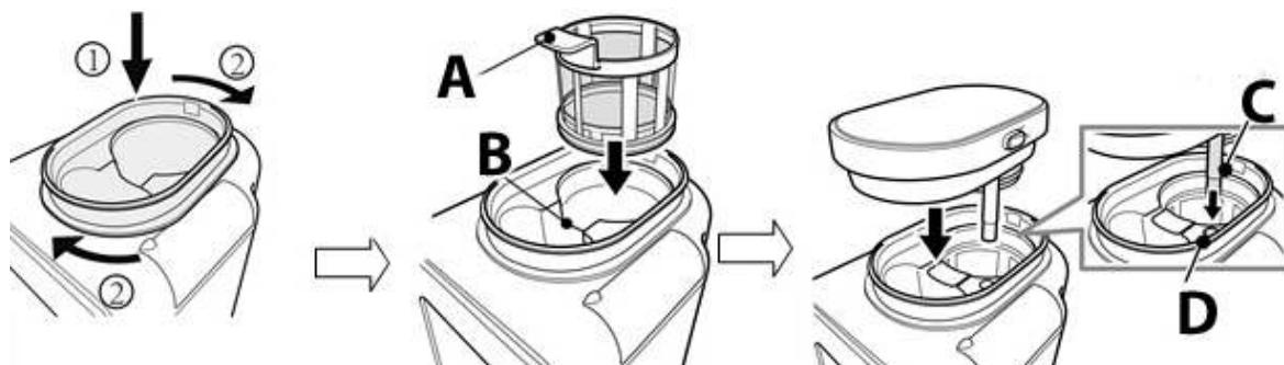
Insérer le récipient de mouture et d'infusion en tournant dans le sens des aiguilles d'une montre jusqu'à entendre un clic (1) et le récipient s'emboite.
