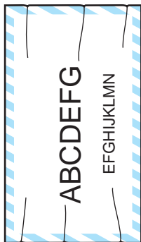
Конверты выходят со складками
